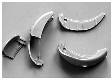
图3 助听器外壳开裂图
