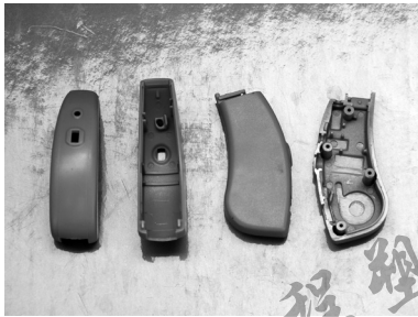
图4 合格的助听器外壳实物图
